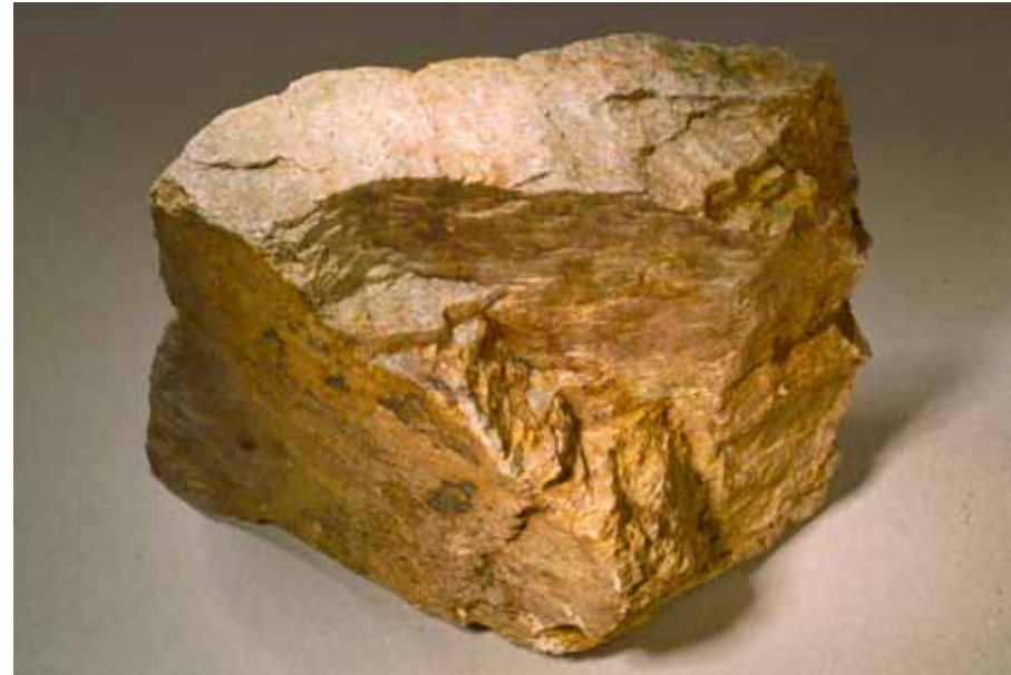
Scharfkantig brechender, sehr harter Schöllkrippener Gneis vom oberen Maschinenschacht im Oberlochborn, Bildbreite 17 cm
