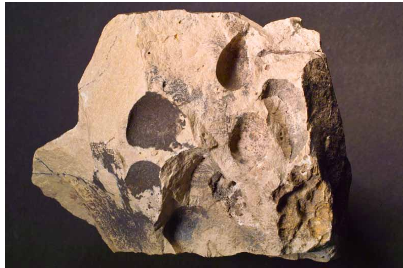
Wenig veränderter Dolomit mit den Hohlräumen ehemaliger Mollusken, deren Schalen aufgelöst wurden, aus einem Steinbruch bei Rodenbach, Bildbreite 8 cm.
