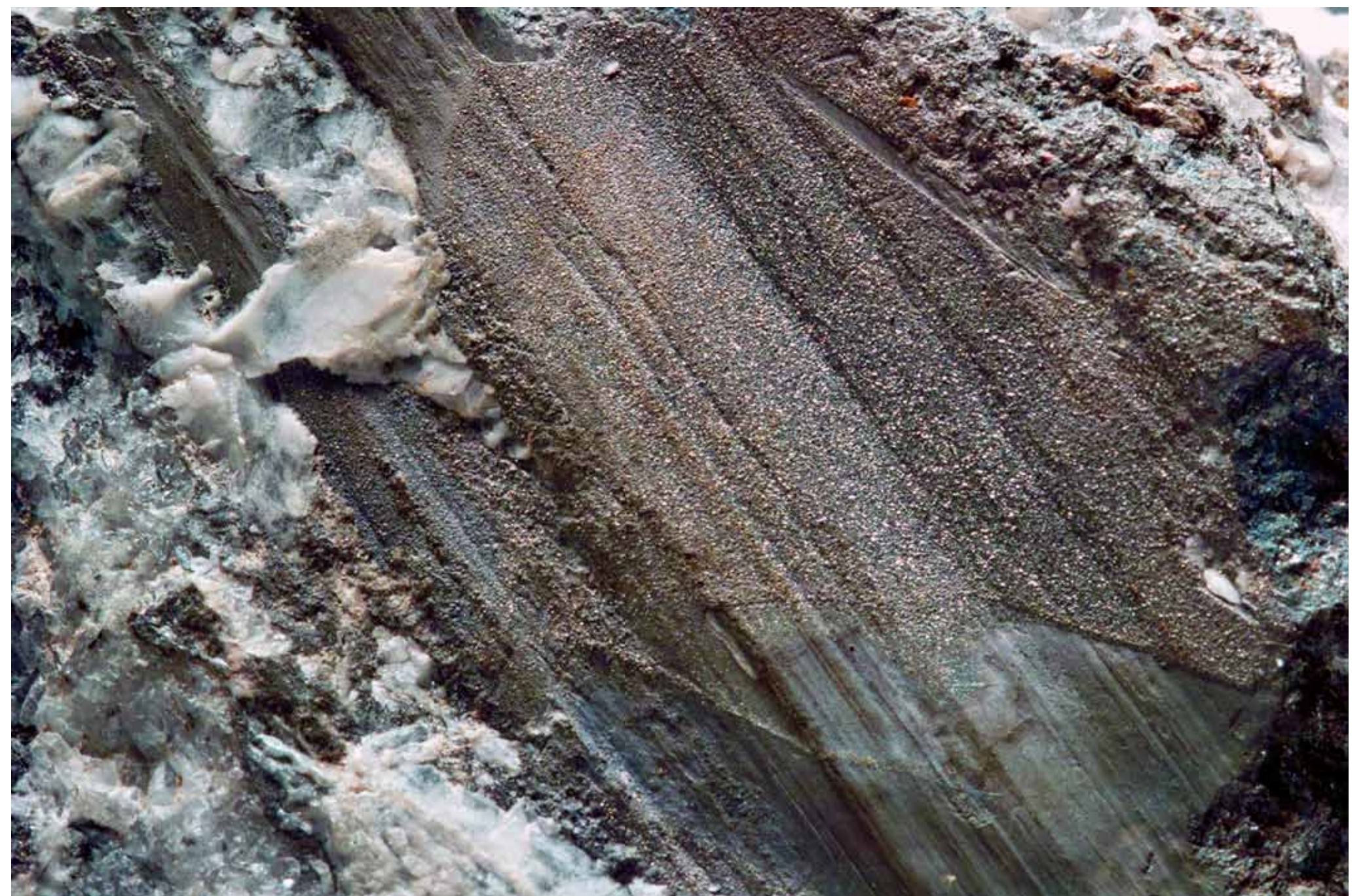
Harnisch (Bewegungsfläche) im Skutterudit mit weißem Baryt aus einem Erzgang in Bieber, Bildbreite 3 cm
