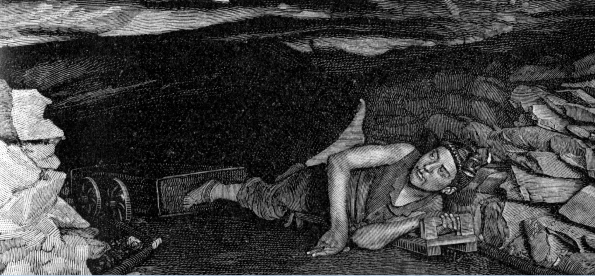
Typische Situation in einem Kupferschieferbergwerk des 18. Jahrhunderts ohne Bewetterung (Belüftung) und elektrisches Licht. Der Trekkejunge zieht den kastenförmigen Grubenhunt mit dem Fuß hinter sich her. Man beachte auch das Geleucht (Lampe) am Kopf. Infolge der geringen Höhe konnte man sich ausschließlich kriechend bewegen. Das Holzbrett in der linken Hand diente als Schutz gegen das Aufliegen auf dem Boden. Die aufgestapelten Steine (Versatz) tragen den Berg. Die Abbildung stammt aus dem Mansfelder Bergbau des 19. Jahrhunderts.
