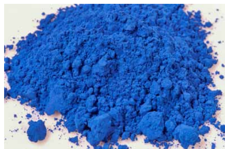
Das blaue Pigment der Smalte, hergestellt aus dem Kobalterz, Bildbreite 4 cm. Unten: Das Blau der Delfhter Kacheln stammt auch aus Bieberer Kobalt.
