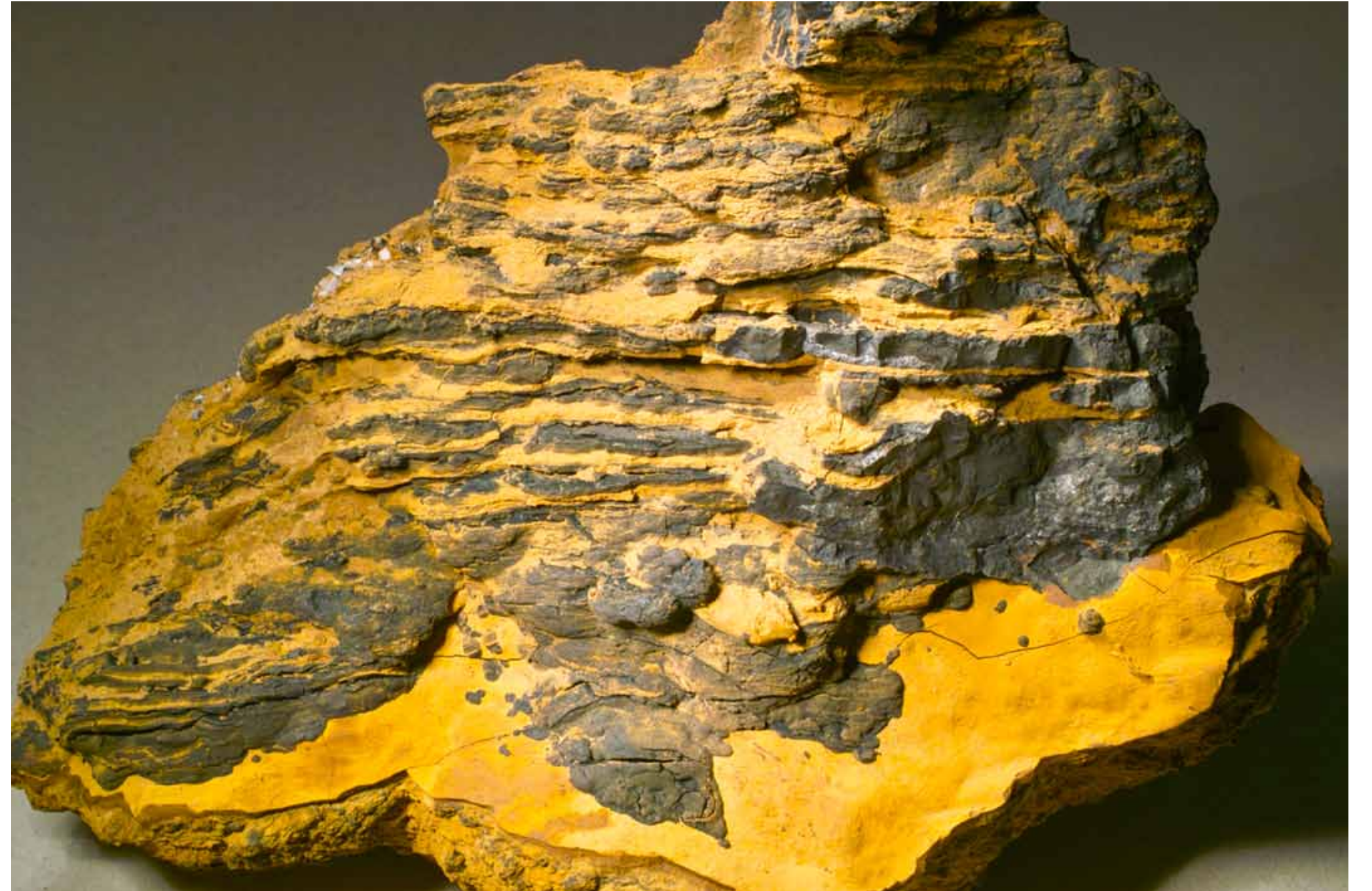
Schwarzer Romanechit in hellbraunem Goethit aus dem Tagebau Nord, ergraben beim Anlegen des Schurfs am 12. April 2014, Bildbreite 15 cm.
